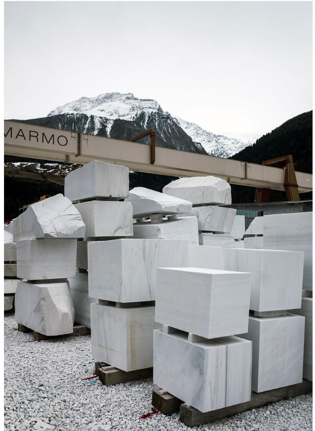
Massive Blöcke mit Transportbohrungen und Bruchkante
